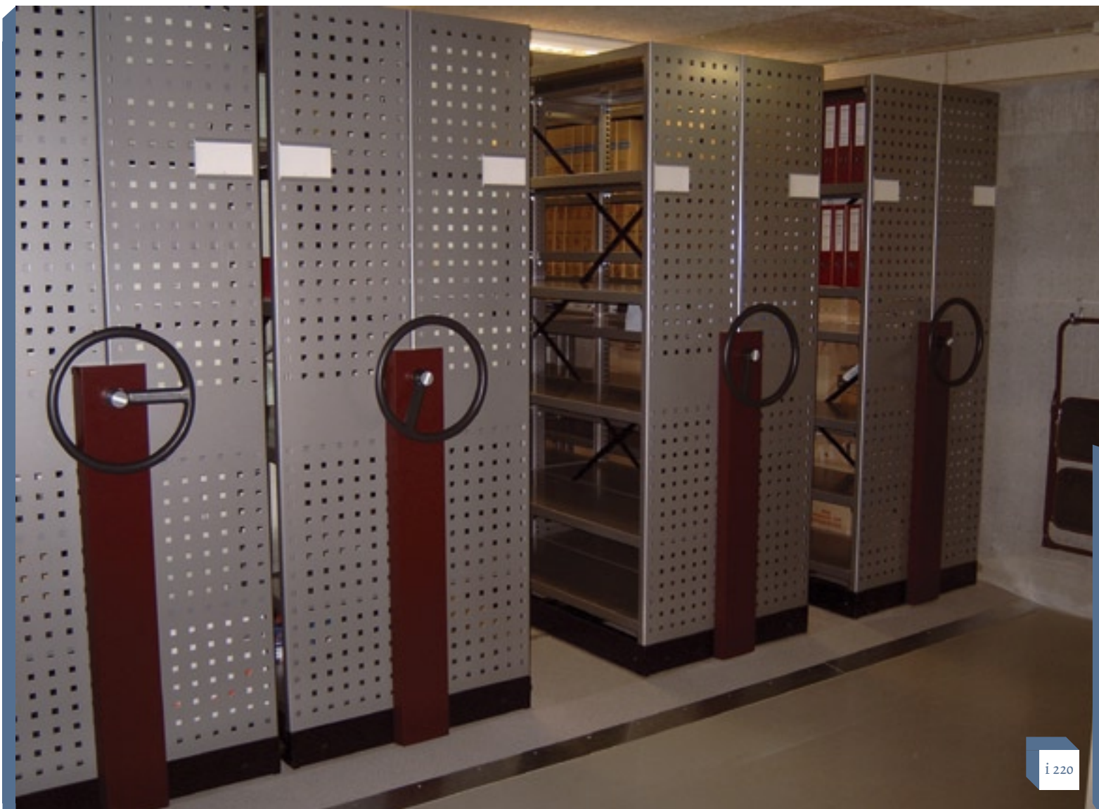
Op slechts ..... vierkante meter zoveel opbergen, kan dankzij het toepassen van verrijdbare stellingen. De kasten zijn verplaatsbaar door middel van een handwiel.
