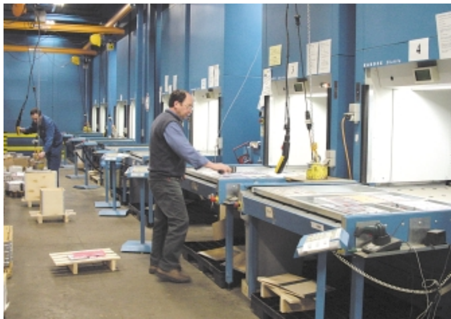
Het halfautomatisch orderverzamelsysteem bij DME is opgebouwd uit 16 paternosterkasten, 8 legbordliften, legbord- en palletstellingen en een centraal rollenbaansysteem met 6 uitsluitlijnen naar de consolidatiezones.
