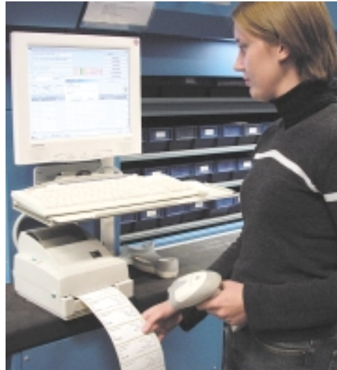
De picker scant de barcodes van het etiket en van de bak waarin hij de order legt. Deze scanning is ook de trigger voor de upload naar het ERP systeem.
