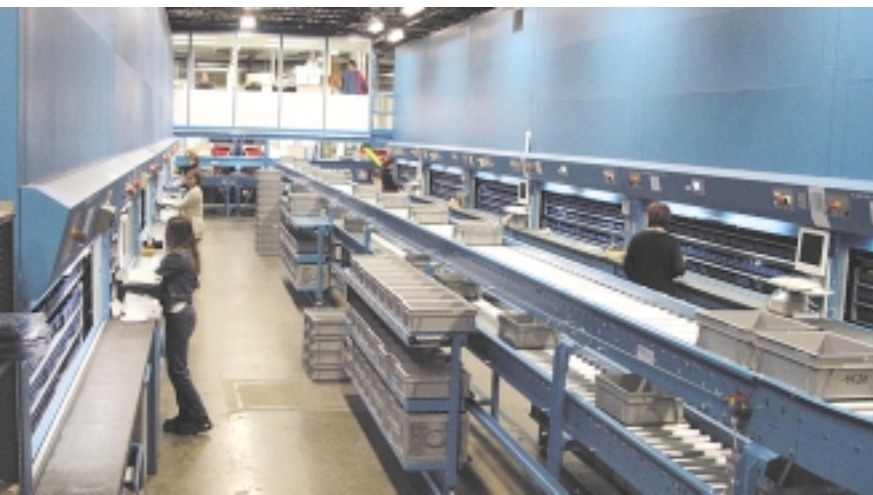
Vanaf de rollenbaan worden de bakken, na automatische scanning van de barcode, naar de juiste consolidatiezone uitgesluisd.
